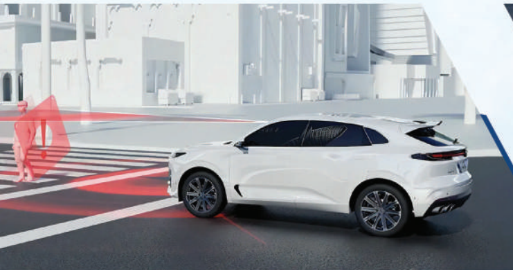
ប្រព័ន្ធផ្តល់សញ្ញាគ្រោះថ្នាក់ ពេលមានឧបសគ្គ និងចាប់ប្រាងដោយស្វ័យប្រវត្តិ
