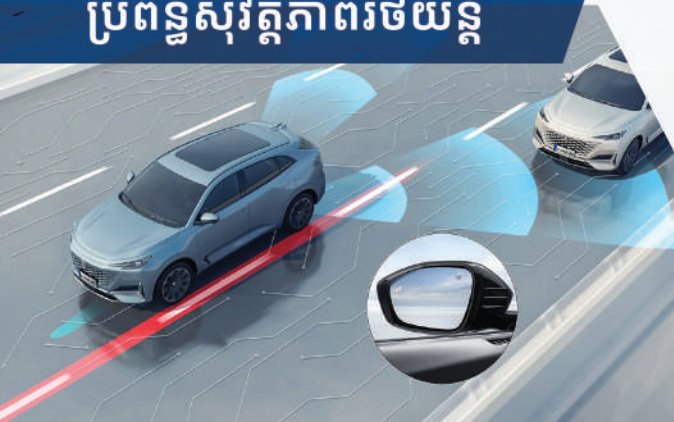
ប្រព័ន្ធផ្តល់ដំណឹងពីការវាជែងដល់អ្នកបើកបរ ពេលមានរថយន្តមកពីក្រោយ
